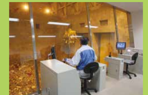
■ごみクレーン運転室 ごみクレーン運転室から遠隔操作で運転します。夜間は自動運転します。
